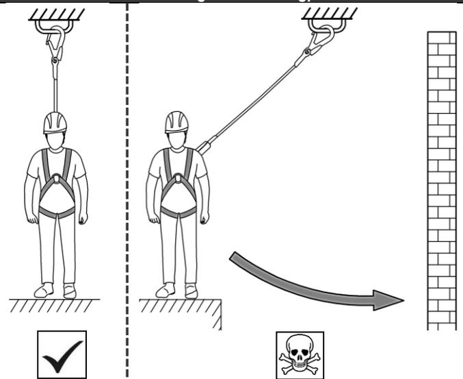
Der Anschlagpunkt muss so hoch wie möglich über dem Benutzer und so nahe wie möglich an der vertikalen Achse des Benutzers liegen, um die Fallhöhe zu verringern und gefährliche Pendelunfälle zu vermeiden!
