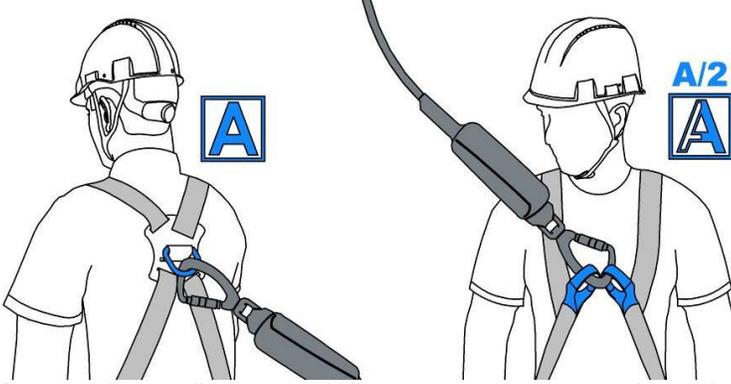
Verwenden Sie nur zertifizierte Auffanggurte (EN 361)! Der Karabinerhaken am Bandfalldämpfer wird an einem der Anschlagpunkte am Auffanggurt (mit „A“ oder „A / 2“ gekennzeichnet) verbunden. Dies sind die einzigen Punkte, die für die Absturzicherung zugelassen sind. Bei einer A / 2-Markierung müssen die beiden Punkte gleichzeitig verbunden werden!
