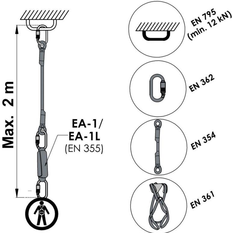
Die maximale Länge des Verbindungsmittels mit Bandfalldämpfer darf 2 m nicht überschreiten. Verwenden Sie zur Verbindung dieser Komponenten ausschließlich nach EN 362-zertifizierte Karabinerhaken. Stellen Sie vor Beginn der Arbeit sicher, dass unterhalb des Arbeitsplatzes genügend Freiraum vorhanden ist! Lesen Sie sorgfältig die Anweisungen jeder Komponente Ihres Systems!
