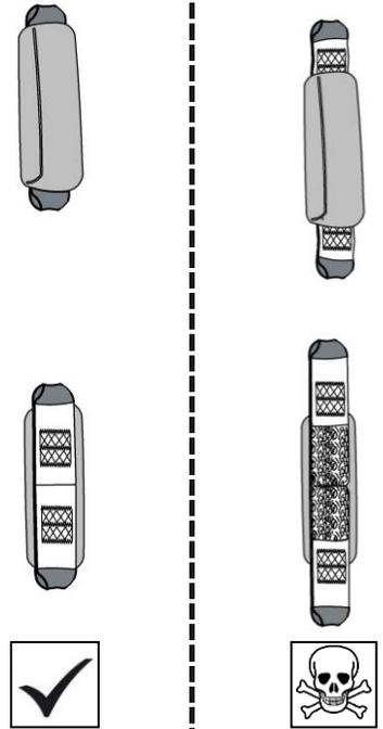
Überprüfen Sie Ihren Bandfalldämpfer bevor Sie ihn verwenden! Verwenden Sie niemals einen Bandfalldämpfer, der beschädigt oder aufgerissen wurde
